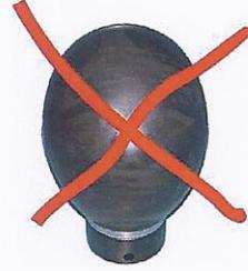
Prüfkopf zu stark aufgeblasen.
