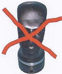
Prüfkopf zu wenig aufgeblasen
