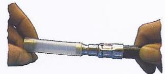
**Prüfdruck +7,5 mbar****Prüfzeit 60 sec.****Zulässige Änderung ±1 mbar****Dichtprüfung Lungenautomat mit Mitteldruck****ACHTUNG: Reihenfolge unbedingt beachten!****Lungenautomat vom Geräteanschluss entfernen****Überdruckfunktion des Lungenautomaten wegschalten**
