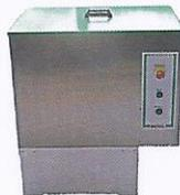
Für die Reinigung, Desinfektion und Trocknung von max. 9 Atemschutzmasken in einem Durchgang (ca. 4h). Automatischer Programmablauf mittels SPS Steuerung, Automatische Zumischung des Desinfektionsmittel, variabel von 0,5 bis 5% einstellbar. Trocknung mittels Warmluftgebläse mit max. 50°C.
