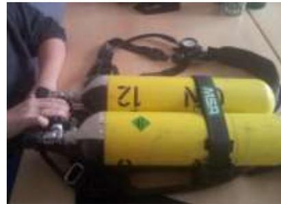
Das T-Stück mit montierten Flaschen zurückziehen bis Flaschen parallel am Grundgerüst liegen,
