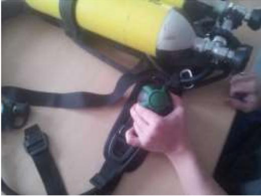
Lungenautomat durch Drücken beider Druckknöpfe aus der Halterung nehmen,
